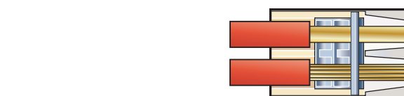
HelaCon Plus - nowatorskie rozwiązanie podwójnej sprężyny dociskowej.
