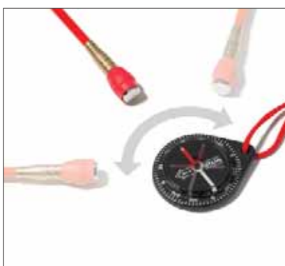
Do trasowania i łatwej lokalizacji końca drążka przez ścianę używa się kompasu współpracującego z silnym magnesem.
