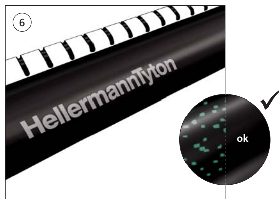
6 Punkty termochromatyczne (TCP) po zewnętrznej stronie rękawa naprawczego pełnią rolę wskaźnika optymalnego obkurczania, ponieważ rozmywają się momencie nagrzania do odpowiedniej temperatury.
