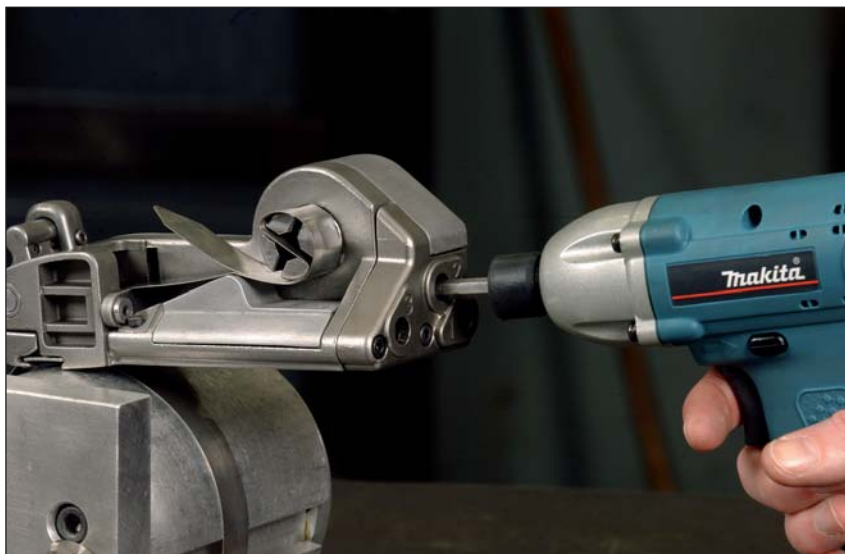
Prosty w użyciu AMTS przyspiesza montaż ciężkich opasek metalowych.
