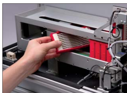
Proste przygotowanie automatu M-BOSS do pracy. Szybkie zakładanie i wyjmowanie kaset.
