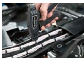
Opaska może być obcięta w dowolnym miejscu.
