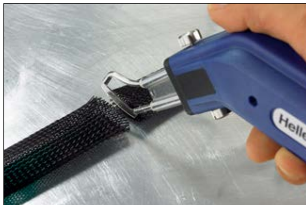
Cięcie przy pomocy HSG0 zapobiega strzępieniu się oplotów.
