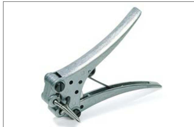
Szybka i bezpieczna aplikacja oznaczników i tulejek przy pomocy rozwieraka trójzębnego NA.
