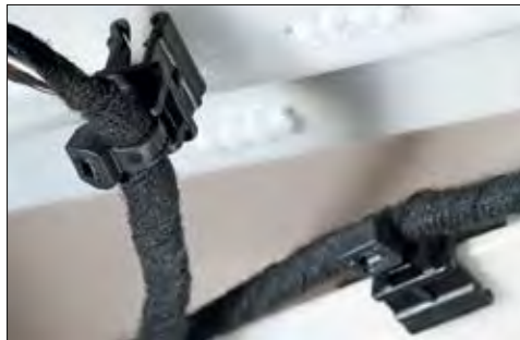
T50ROSEC10 założony na krawędź z tworzywa sztucznego.
